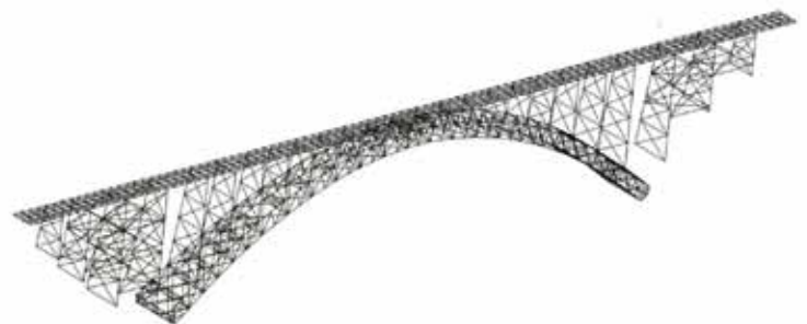
Fig. 2. Modelo actual 3D, elaborado para cálculos de verificación mediante ordenador
